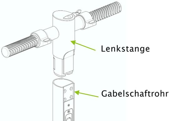
**2. Befestigen Sie die Lenkstange mittels der mitgelieferten Schrauben und nutzen Sie dafür einen Drehmomentschlüssel. Das Anzugsmoment für die Schrauben beträgt 5 NM.**
