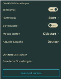
Unter den drei Buttons befindet sich der Fahrmodi-Auswahlbutton, die Tempomatsteuerung und der Button für die erweiterten Einstellungen.
