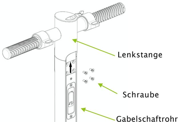
**⚠ VORSICHT:** Der mitgelieferte Schraubenschlüssel dient nur zur Vormontage. Die Schrauben müssen mittels eines Drehmomentschlüssels mit dem angegebenen Drehmoment angezogen werden.
