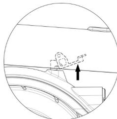
Stellen Sie sicher, dass Ihr comscoot performance ausgeschaltet ist. Um ihn zusammenzuklappen, entriegeln Sie den Klappmechanismus (zuerst 1, dann 2) und biegen Sie den Lenkervorbau um. Diesen rasten Sie dann am hinteren Schutzblech ein. Zum Öffnen ziehen Sie die Lasche (3) an der hinteren Einhängevorrichtung am Schutzblech. Nun können Sie den Lenker aufstellen und den Klappmechanismus verriegeln.
