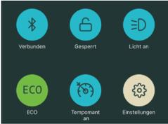
Wenn Sie die Wegfahrsperrung aktiv haben, blockiert das Hinterrad und der E-Scooter lässt sich nicht fahren und nur schwer schieben. Die Wegfahrsperrung bleibt auch aktiv, wenn die App beendet wird. Der E-Scooter lässt sich bei aktiver Wegfahrsperrung auch nicht am Knopf ausschalten.
